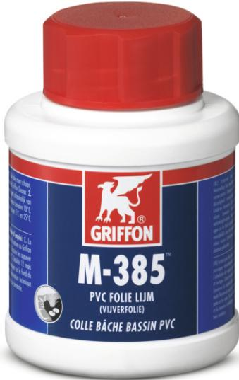
**TECHNISCHE EIGENSCHAFTEN****Wasserbeständigkeit:** Sehr gut**Chemische Beständigkeit:** Beständig gegen Öl, Basen und verdünnte Säuren**Elastizität:** Gut**TECHNISCHE SPEZIFIKATIONEN****Basis:** Lösung aus Polyurethanskautschuk in einer Mischung aus Lösungsmitteln.**Farbe:** Transparent**Viskosität:** ca. 2500 mPa/s**Feststoffgehalt:** ca. 16 %**Dichte:** ca. 0.87 g/cm<sup>3</sup>**Flammpunkt:** K1 (< 21 °C)**LAGERUNGS BEDINGUNGEN**
